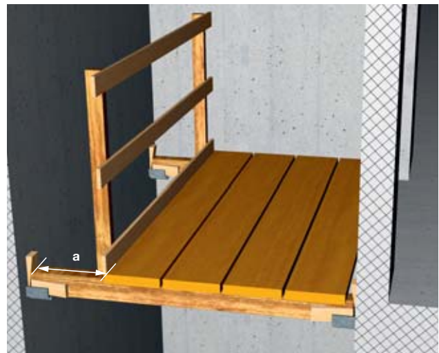
6 Lorsque la distance [a] dépasse 30 cm, une protection latérale permet de prévenir les chutes.
