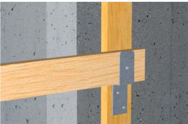
18 Barre de protection latérale simple. Le plateau est assuré par un clou.
