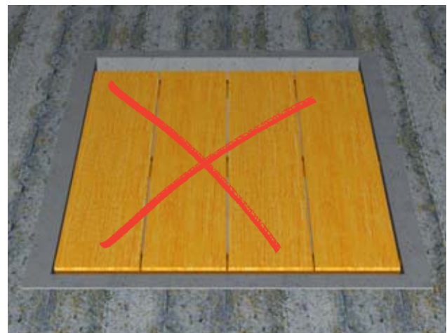
3 Les panneaux de coffrage sont à l'origine de nombreux accidents. Ils ne doivent jamais être utilisés comme plateaux d'échafaudage.
