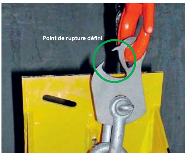
21 Contrôle de la capacité portante des points de suspension et d'ancrage: élément d'essai à point de rupture défini.
