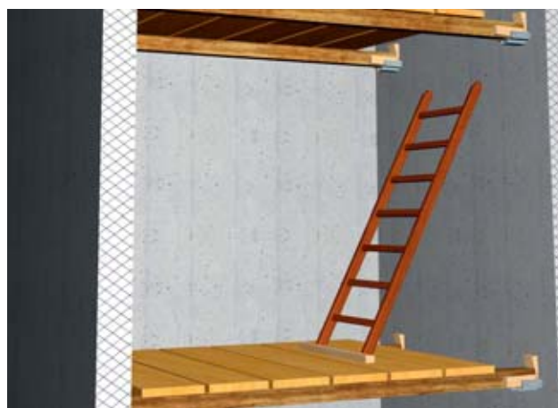
13 La sécurité des travaux effectués sur une échelle n'est assurée que lorsque celle-ci est utilisée correctement (angle d'inclinaison de 70° environ, échelle assurée contre le glissement et en état impeccable).
