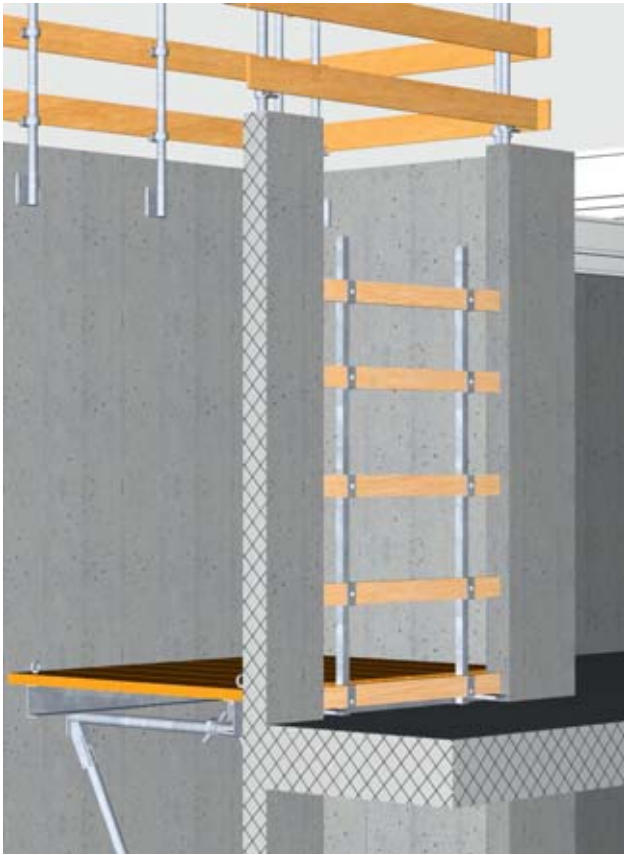
24 a Protection latérale dans des équerres de décoffrage
